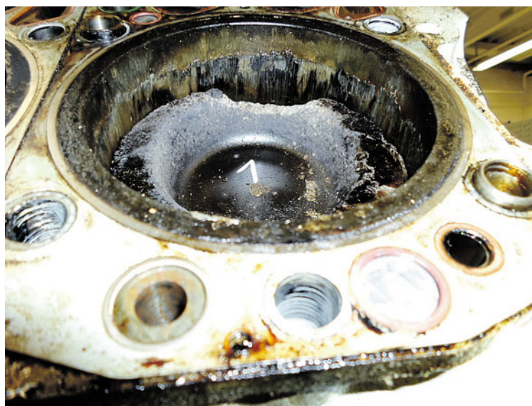
Ein geschmolzener Kolben sorgte hier für einen Motorschaden.
