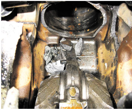
Ein abgerissener Pleuel hat ein Loch im Motorblock verursacht.
