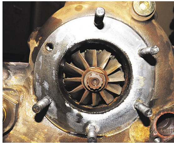
Beschädigtes Turbinenrad eines Abgasturboladers.
